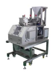
プロムシリーズは高磁力マグネットを応用して、製品とその中に含まれる異物の落下曲線を変化させ、選別する装置であり、従来はベルト式を採用していました。
